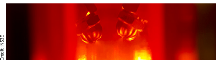
Système de buses injectant le précurseur dans le réacteur.
